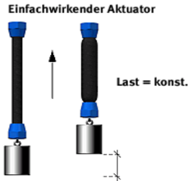
Abb. 1.10 Kontraktion des Aktuators
