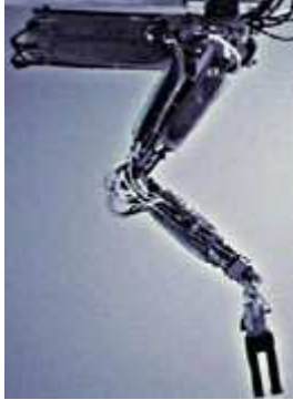
Abb. 1.6 Roboterarm mit pneumatischen Muskeln
