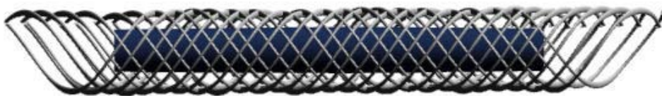
Abbildung 3 Inner Aufbau des pneumatischen Muskels
