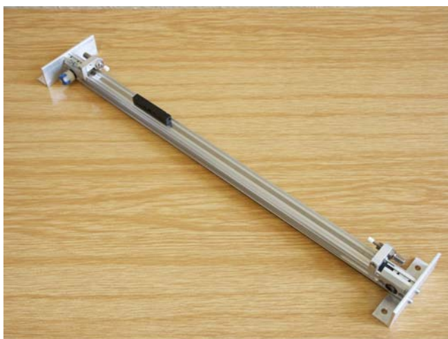
Abb. 21: Linearführung mit montierten Winkelblechen, Endlagendämpfern und Kupplung.
