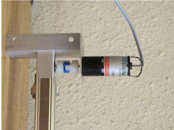
Abb. 22: Ankopplung des Antriebsmotors (Maxon A-max 22 mit Getriebeaufsatz) an die Linearführung mit Hilfe der Rotex-Kupplung
