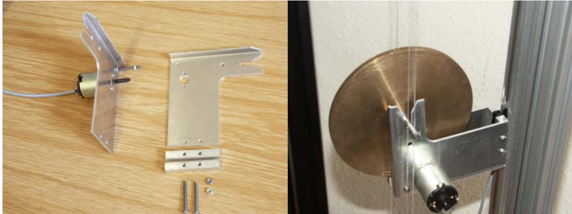
Abb. 20: Links – Demontierte Einzelteile des Schlittens. Zwei Schalen aus 2mm Alublech (eine davon mit montiertem Wickelmotor), zwei Abstandhalterklötzchen, M3 Schrauben und Muttern. Rechts – Schlitten mit Jojo in der Lagerschale.
