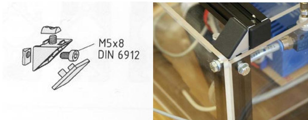
Abb. 18: Der Winkel kann entweder mit Nutensteinen in den Führungsnuten angebracht, oder an der Stirnseite eines Profils angebracht werden. Im zweiten Fall muss noch ein entsprechendes Gewinde vorgesehen werden.
